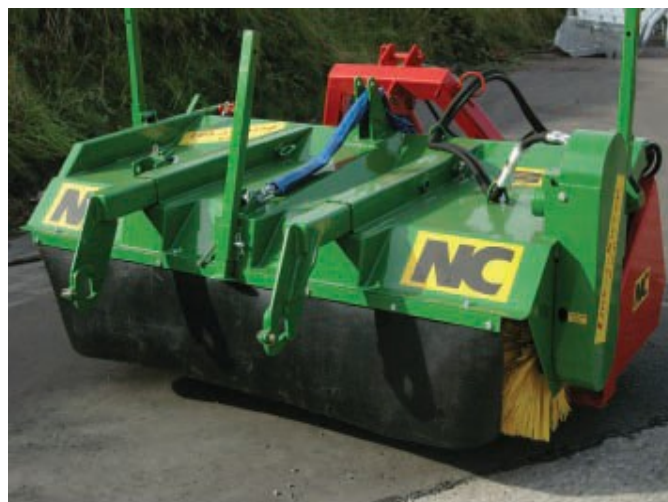
Zvedací ramena a konzola pro zvedání zametacího zařízení jako volitelné příslušenství
