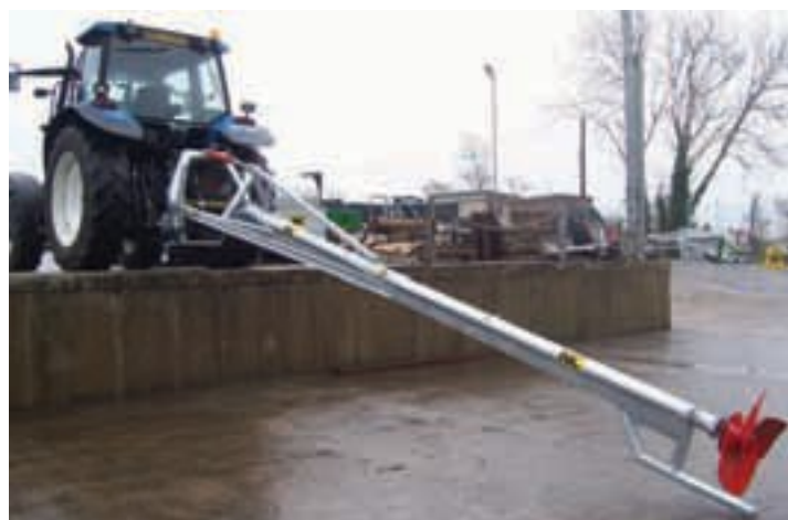
Míchací zařízení pro kalové rybníky
